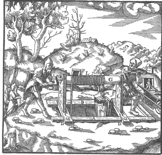
Der vorn am Schacht verlegte Pflühbaum A. Der hinten am Schacht verlegte Pflühbaum B. Die zugespitzten Pfähle C. Die Querhölzer D. Die Halbpflühen E. Die Pfadesen F. Der Rundbaum G. Seine Zapfen H. Das Holz I. Die Kurbel K. Das Förderseil L. Der Seilhaken M. Das Fördergefäß N. Sein Bügel O.
