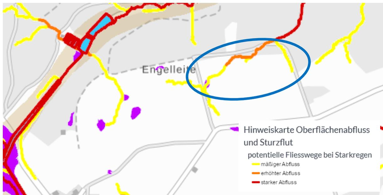
Abb. 9 Darstellung der potenziellen Fließwege bei Starkregen gemäß Hinweiskarte „Oberflächenabfluss und Sturzflut“ mit Kennzeichnung des Planungsgebiets (schematisch blau umrandet) – ohne Maßstab
